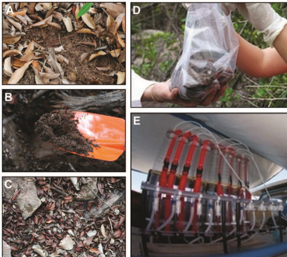
Figura 8. Coleta das amostras de solo e esquema de filtração das amostras de água. (A) Aspecto geral do ponto de coleta 1; (B e C) Coleta no ponto 2; (D) Armazenamento do solo; (E) Esquema de filtração Niskin com filtros acoplados.
