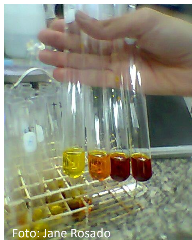
Figura 14: Dosagem dos açúcares redutores pelo método DNS. Em: A) amostras sendo aquecidas em placa aquecedora; B) Mudança de coloração após o aquecimento. Fonte: A autora
