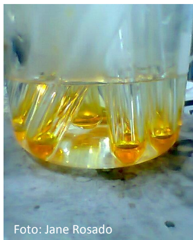
Figura 14: Dosagem dos açúcares redutores pelo método DNS. Em: A) amostras sendo aquecidas em placa aquecedora; B) Mudança de coloração após o aquecimento. Fonte: A autora
